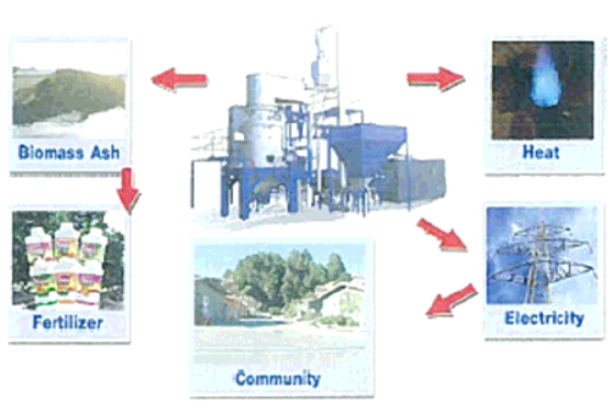
รูป 8.4.3 หลักการระบบแก๊สซิฟิเคชันของสารชีวมวล
