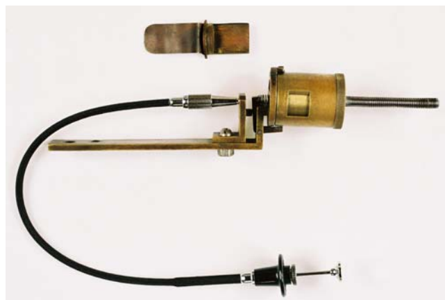
写真4 (故)棚澤泰先生の回転シャッター式噴霧粒採取器 (株式会社豊田中央研究所の協力による)
