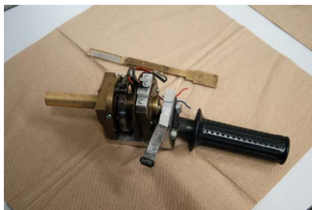
写真5 柄沢先生の回転シャッター式噴霧粒採取器
