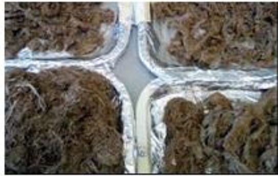
Gambar 8.5.5. Hasil ledakan uap pada jerami.
