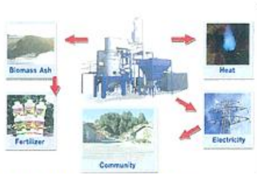
Gambar 8.4.3. Konsep sistem gasifikasi biomassa.
