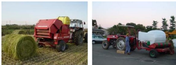
Gambar. 5.6.3 Pembuatan bal gulungan silase (kiri) dan pembungkusan (kanan) dari jerami padi.
